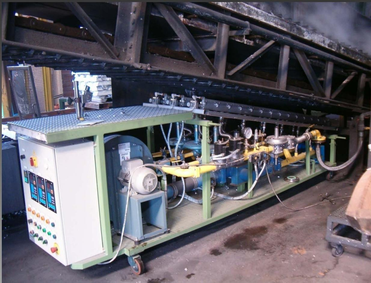
Система подогрева конвейера ESA: производственная установка
