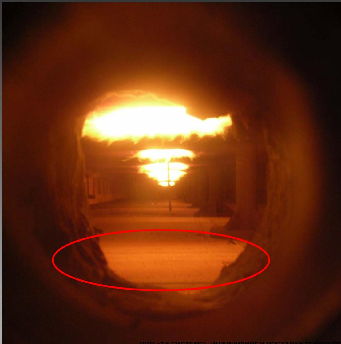
Горелки ESA SW установлены в печи промежуточного нагрева.
